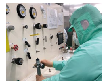
高圧ボトル レギュレーター試験
