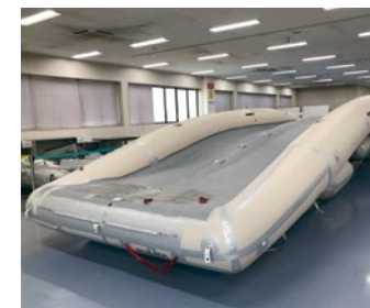
エバキューエーション・スライドの整備
