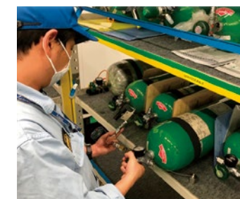
高圧ボトルの整備
