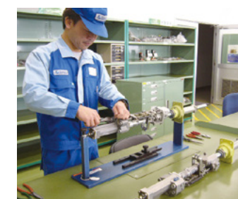
サーボ・シリンダー&アクチュエーター 油圧による回転翼機ブレードの制御
