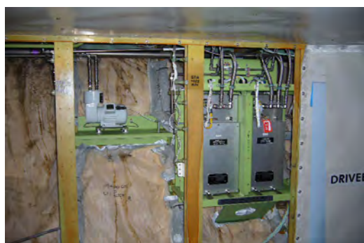
777-200ER 型機 (JA707J) の後方貨物室に取り付けられた自動大気サンプリング装置 (ASE)
