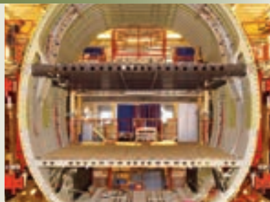
エアバスA380 ADP製法による胴体2階床炭素繊維構造部材 (写真提供：エアバス社)
