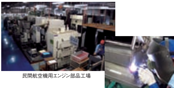
ヒートエクスチェンジャーの溶接
