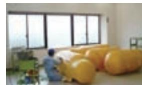
エマージェンシーフロート(ヘリコプターが不時着水するときに、機体が水没することを防ぐために膨らませる非常用の浮き袋)の整備
