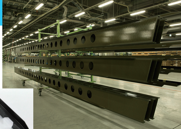
エアバス機に使用される炭素繊維構造部材
