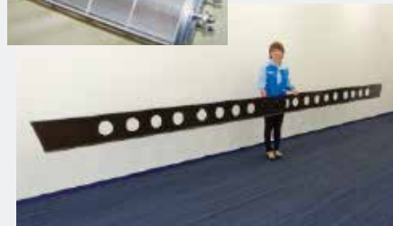
ADP製法のCFRP部材
