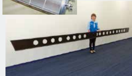
ADP製法のCFRP部材
