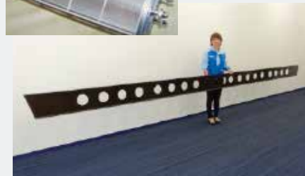
ADP製法のCFRP部材
