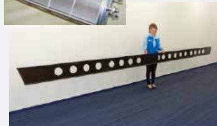
ADP製法のCFRP部材
